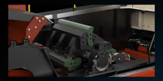
Inclui lança de elevação, guincho de corrente e suporte de elevação integrados para remoção, rotação e montagem segura de martelos
