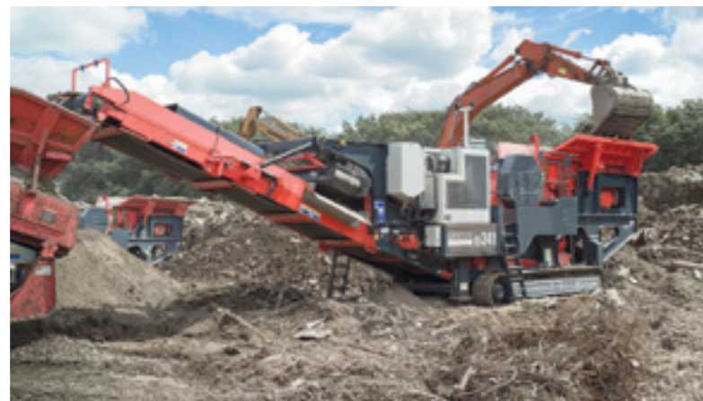
Braço hidráulico opcional com martelo e extensões de tremonha disponíveis.
