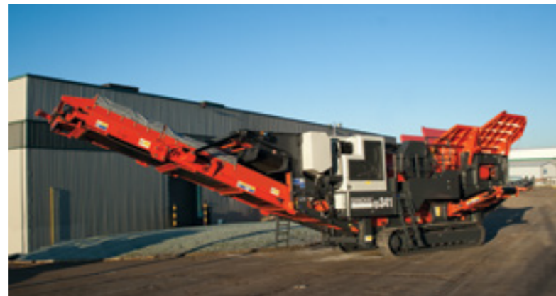
Braço hidráulico opcional com martelo e extensões de tremonha disponíveis.
