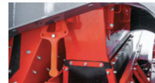
Rampa de desvio de três posições
