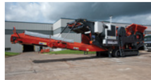
Instalação hidráulica de levantamento/abaixamento no transportador principal para maior libertação
