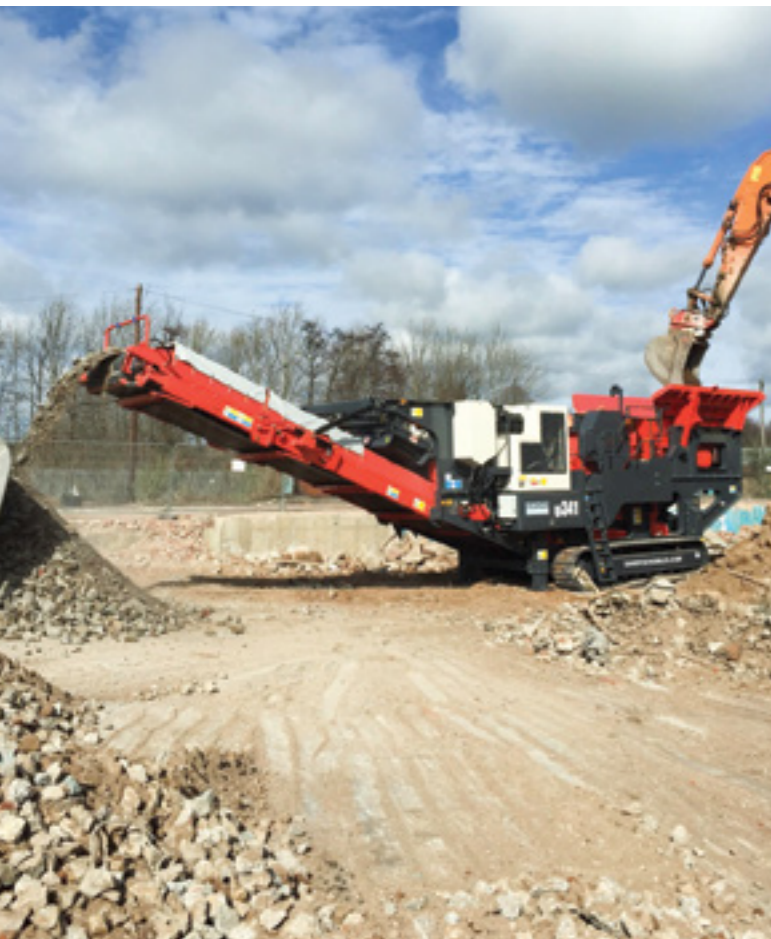
Braço hidráulico opcional com martelo e extensões de tremonha disponíveis.
