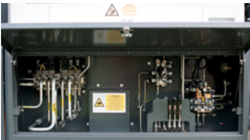
Acesso do solo aos componentes hidráulicos
