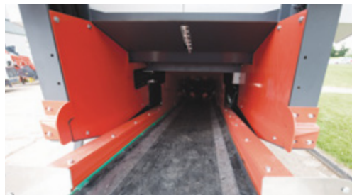
Boca do tapete de alimentação principal melhorado para actividades de limpeza e manutenção
