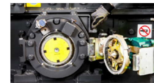
Dispositivo patenteado de bloqueio e posicionamento do rotor para maior segurança
