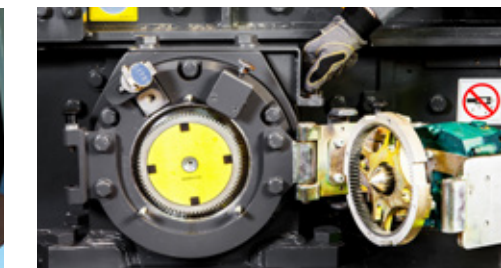
Dispositivo patenteado de bloqueio e posicionamento do rotor para maior segurança
