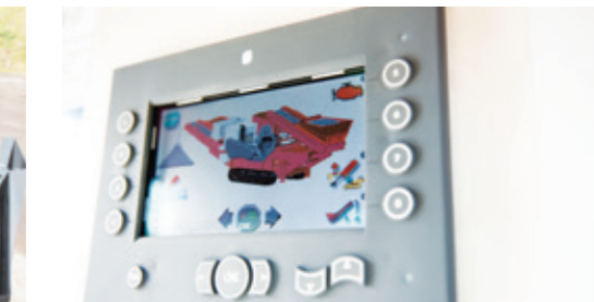
Sistema de controlo PLC de fácil utilização com ecrã a cores
