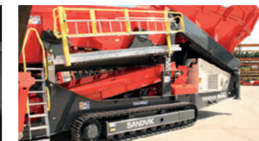
Dispositivo de elevação instalado permitindo um fácil acesso a todo o lado
