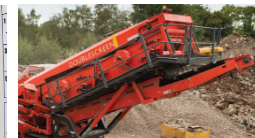
Pasarelas de plegado hidráulico para facilitar el mantenimiento
