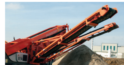
Dispositivo de giro y elevación / descenso hidráulicos
